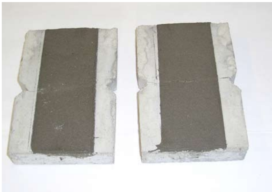
Рис. 1.6. Внешний вид образцов бетона с покрытием для испытаний на трещиностойкость.
