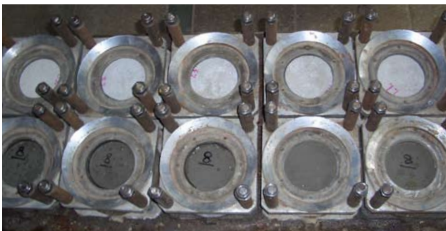
Рис. 1.1. Установка для испытаний образцов на водонепроницаемость.
