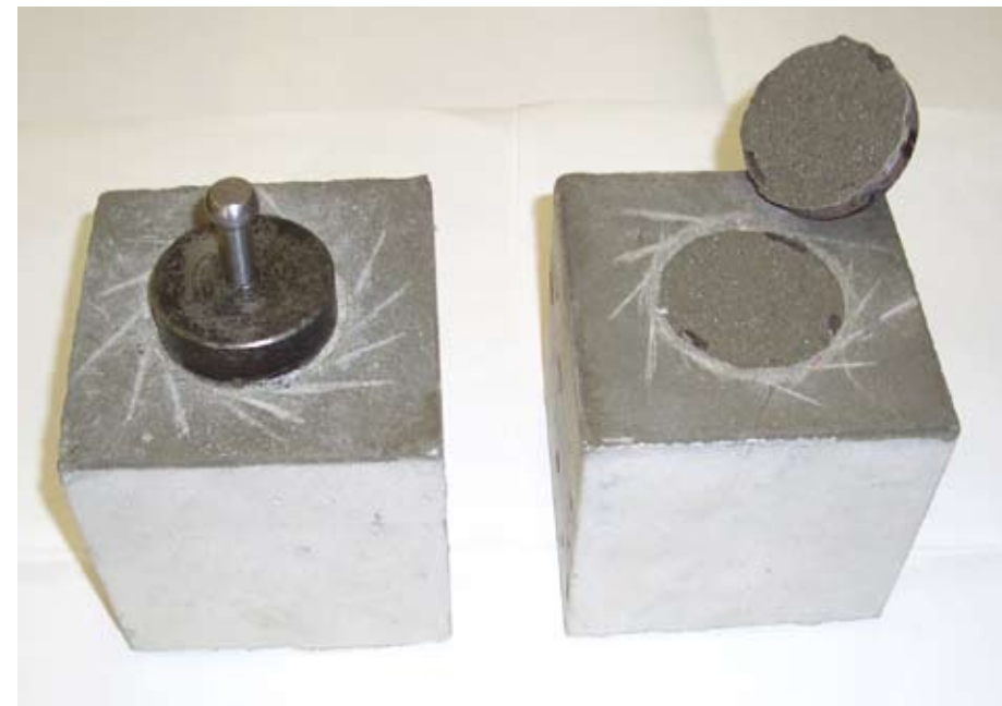
Рис. 1.5. Внешний вид образцов бетона с покрытием Mapelastik до и после испытаний на адгезию.
