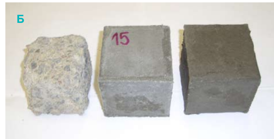
Рис. 1.2. Внешний вид образцов после испытаний на морозостойкость.
